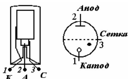
Рис. 1 Порядок расположения электродов тиаратрона тлеющего разряда МТХ-90
