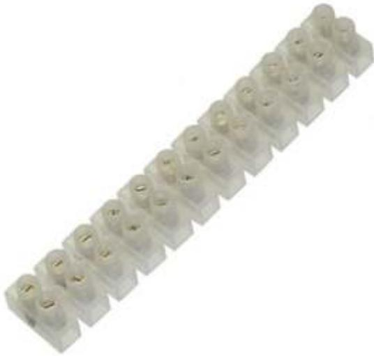
Клеммные колодки серии РА предназначены для парного соединения проводов сечением от 1,5 до 10 мм<sup>2</sup> в силовых распределительных электрощитах. Метод соединения \* винтовой.
